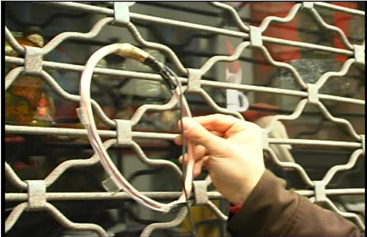
6- enlever le vernis du cuivre à l'aide d'un briquet et d'un cutter. pour pouvoir connecter le cuivre à un connecteur audio du type jack (3,5 ou 6,5mm)
